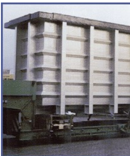
Rysunek 1. Zbiornik do galwanizacji wykonany z polipropylenu (PP) technikami spawania. Szkielet jest stalowy pokryty przyspawanymi profilami z PP.
