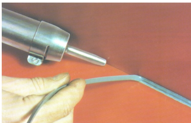
Rysunek 6. Zobrazowanie prawidłowego nadlewu-wypływki przy wahadłowym spawaniu utwardzonego polichlorku winylu (PVC) i profilowanego pręta spawalniczego PVC.
